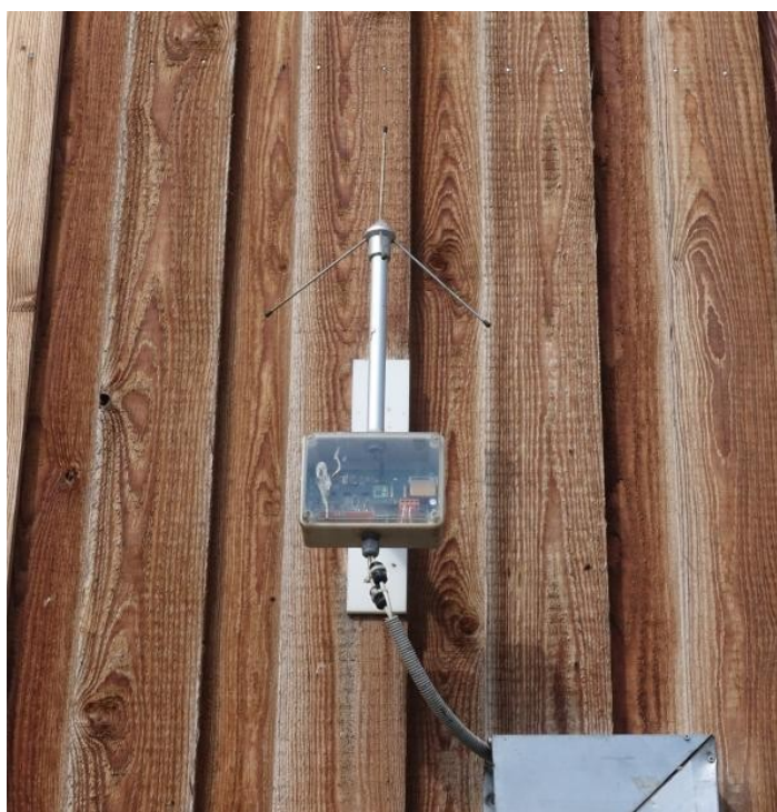
Obrázek 7: Přijímací anténa EROS 868MHz, zdroj: vlastní
