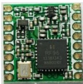
Obrázek 2: Rádiový modul RFM95W, zdroj: www.hoperf.com
