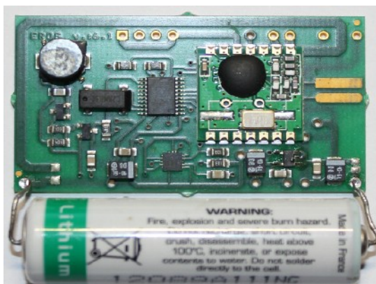
Obrázek 3: Elektronika snímacího zařízení EROS, zdroj: vlastní
