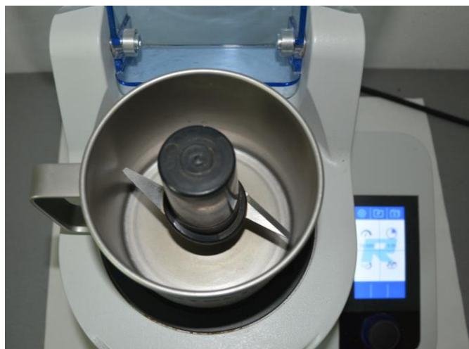
b) Detail mlecí komory a nože mlýnu Grindomix GM 200 (Retsch, Německo)
