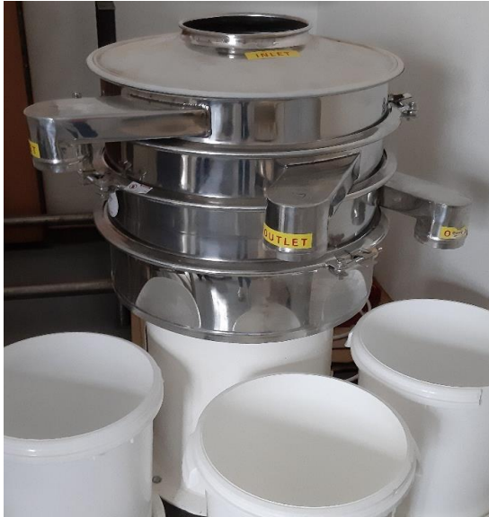
a) Vibrační třídič S49-600-3S s možností osazení třemi sítí o průměru 600 mm
