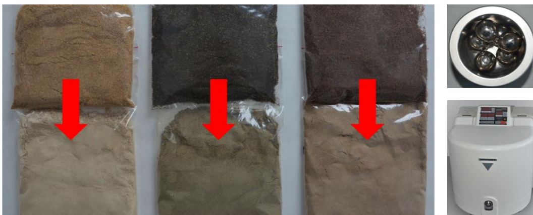
Obr. 49: Efekt finální úpravy velikostní frakce výliskové mouky 500 – 700 \mu\text{m} pomocí mletí na planetovém mlýnu (Zdroj fotografií: J. Bárta)
