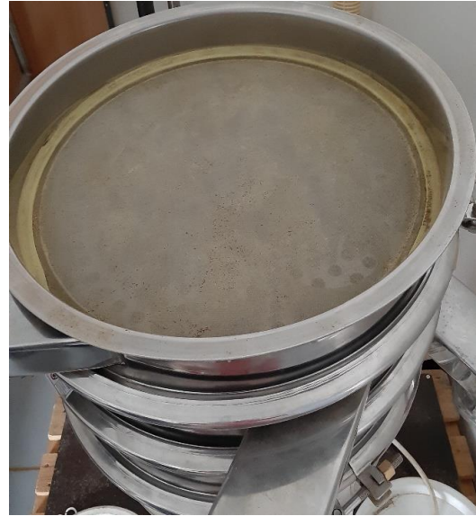
b) Síta z nerezové oceli o průměru 600 mm s oky 160, 315 nebo 485 \mu\text{m}
