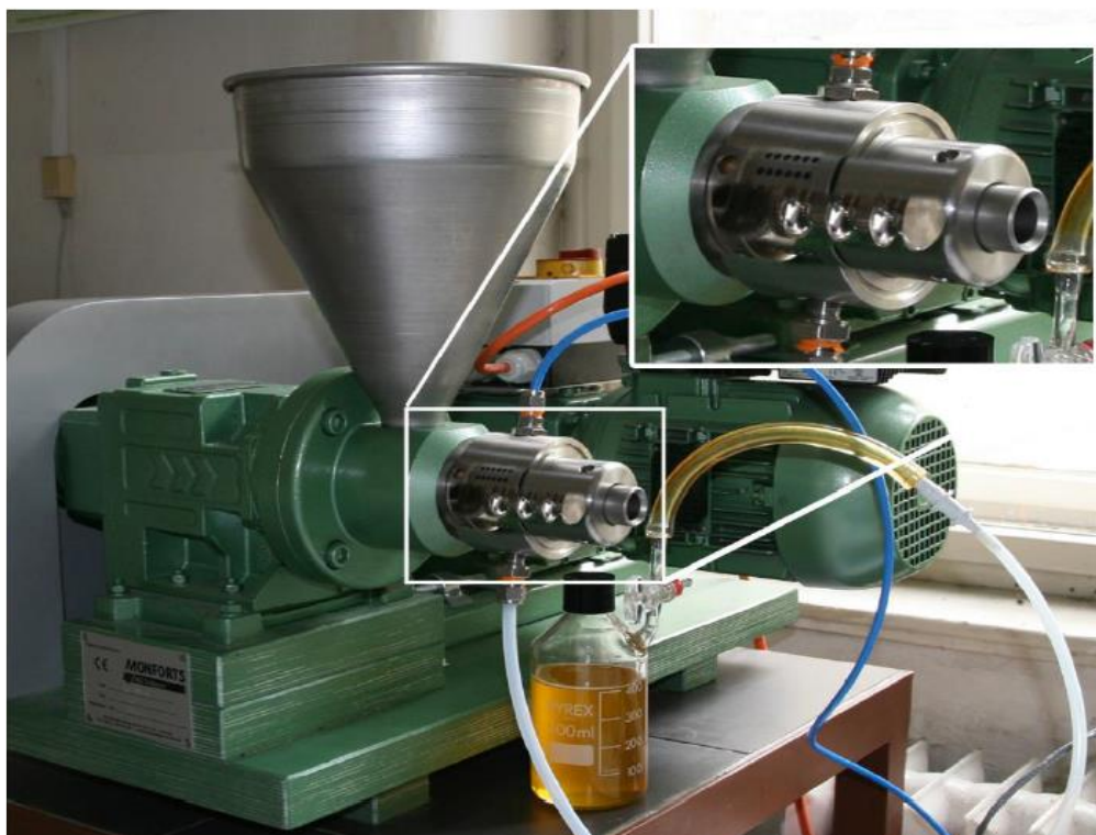
Obr. 27: Technologické provedení šnekového lisování v ochranné atmosféře argonu (Foto: J. Kyselka)
