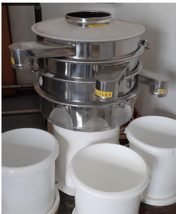
Obr. 4 Zařízení pro prosévání pomleté vstupní výliskové mouky pro vznik frakcí s různým obsahem bílkovin
